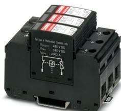
Überspannungsableiter für 2-polige isolierte und geerdete PV-Gleichspannungssysteme 1000 V DC, für Tragschienenmontage, 3-poliges Basiselement, drei steckbare temperaturüberwachte Schutzmodule, Statusmeldung an jedem Stecker.
