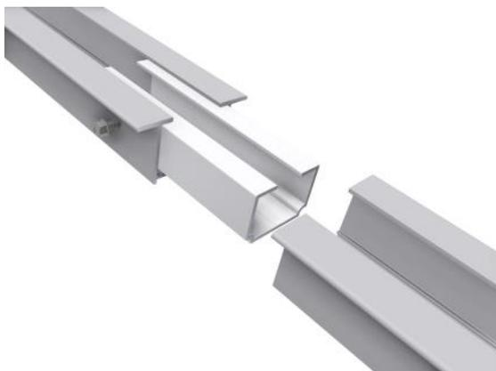
Sollte die Länge der Vertikalprofile nicht ausreichen, so können weitere Profile mittels der Vertikalverbinder, angeschlossen werden. Die Vertikalverbinder werden gleichmäßig in die Vertikalprofile eingeschoben und mittels einer Bohrschraube fixiert. Die Verbindung der Vertikalprofile stellt eine biegesteife Verbindung dar.
