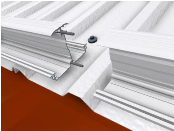
Die Horizontalprofile werden mittels Verbindungsbolzen in den Steckkanälen des Profils zusammengefügt, so dass sich die Generatorgesamtweite ergibt. Zwischen den Profilen sollte immer ein Abstand von 1-2 mm sein, um temperaturbedingte Längenausdehnungen auszugleichen. Die Horizontalprofile werden in 2 Meter Längen geliefert. Bei Bedarf sind sie mit einer Kappsäge auf Länge zu schneiden.
