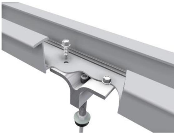
Nachdem die Vertikalprofile ausgerichtet sind, werden sie mit je 2 Bohrschrauben am Vertikalaufsatz des Solarbefestigers befestigt.
