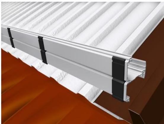
Zwischen Horizontalprofil und dem Trapezblech kommen die Korrosionsschutz Gummis, diese werden jeweils im Bereich der Hochsicke auf das Profil geklemmt und zusammen mit diesem verschraubt. Es können auch mehrere übereinander, zum Ausgleichen von kleineren Unebenheiten, genutzt werden.
