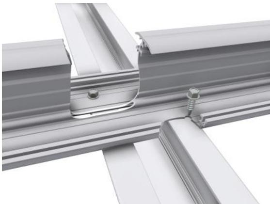
Die Befestigung der Horizontalprofile erfolgt mittels zwei Bohrschrauben je Knotenpunkt, welche diagonal versetzt in die obere Auflagefläche des Vertikalprofils geschraubt werden. Das Horizontalprofil muss mit 6,0 mm vorgebohrt werden.
