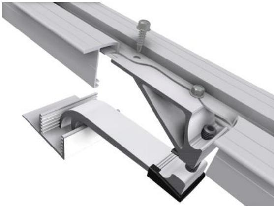
Nachdem die Vertikalprofile ausgerichtet sind, werden sie mit je 2 Bohrschrauben am Vertikalaufsatz des Dachhakens befestigt.
