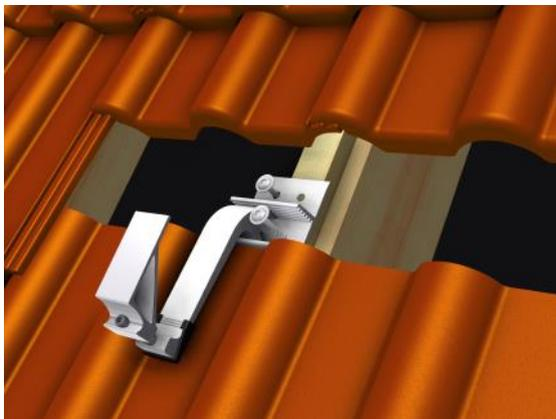
Die Grundplatte (80 mm) wird mittig auf dem Sparren positioniert und mit zwei Holzschrauben (8 x 120 mm) am Sparren verschraubt. Hierbei ist auf einen ausreichenden Holzquerschnitt zu achten und es wird empfohlen vorzubohren.
