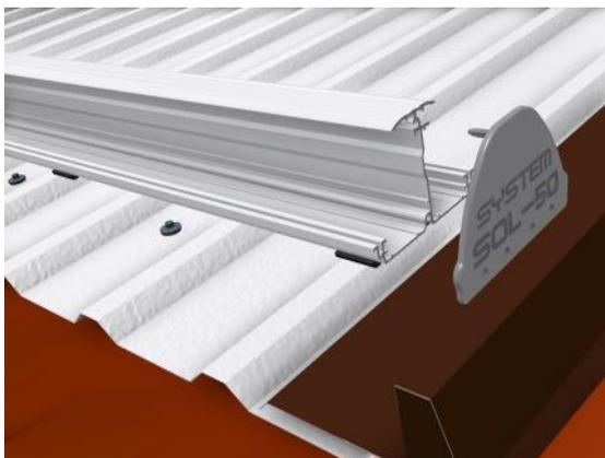
Auf beiden Seiten des Gesamtprofils wird nun eine Horizontalprofil Endkappe in die dafür vorgesehenen Steckkanäle eingedrückt. Das Horizontalprofil ist jetzt über die gesamte Länge zwischen den beiden Abschlussblechen abzusenken, so dass auf jeder Seite ein Luftspalt von ca. 5 mm entsteht.
