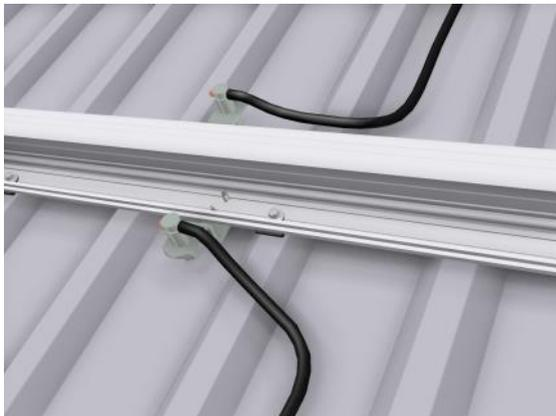
Der Erdungsbausatz wird mit zwei der selbstschneidenden Edelstahlschrauben an einem geeigneten Platz des Dachtrapezprofils befestigt.
