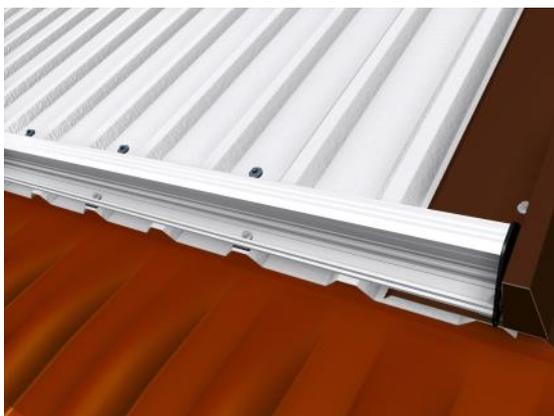
Die Verschraubung erfolgt auf jeder 2. Hochsicke (im Randbereich jede Hochsicke) durch zwei Bohrschrauben in die dafür vorgesehenen Bohrmarkierungen des Horizontalprofils. Das Horizontalprofil muss mit 6,0 mm vorgebohrt werden. Beachten Sie hierzu die allgemeinen Hinweise zur Schraubenmontage.
