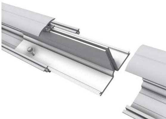
Sollte die Länge der Horizontalprofile nicht ausreichen, so können weitere Profile mittels der Horizontalverbinder angeschlossen werden. Die Horizontalverbinder werden gleichmäßig in die Horizontalprofile eingeschoben und gegen verrutschen, z.B. mittels einer Bohrschraube, gesichert.
