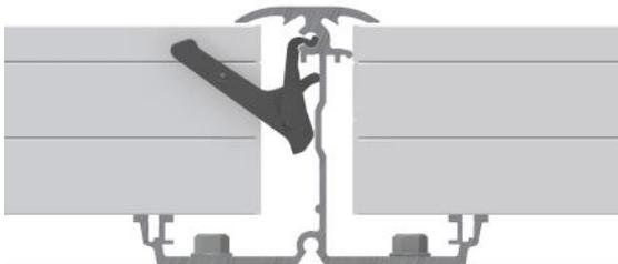
Erst nach dem Einsetzen des benachbarten Moduls wird der Sicherungshebel in der Mitte nach unten umgelegt und eingerastet. Diese Fixierung verhindert, dass das Modul nach oben geschoben und entnommen werden kann (Diebstahlsicherung).
