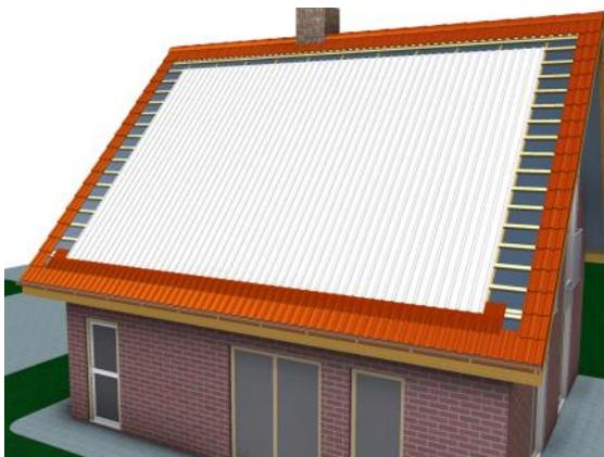
Die komplette Breite der Dachtrapez-Profilfläche, darf nicht breiter und max. 170 mm schmaler sein als die Generatorbreite, um einen optimalen Anschluss der seitlichen Eindeckbleche zu erreichen. Die komplette Höhe der Fläche sollte 300 mm höher sein als die Generatorhöhe, um die Dichtigkeit im oberen Dachanschluss durch die Dacheindeckung zu gewährleisten.
