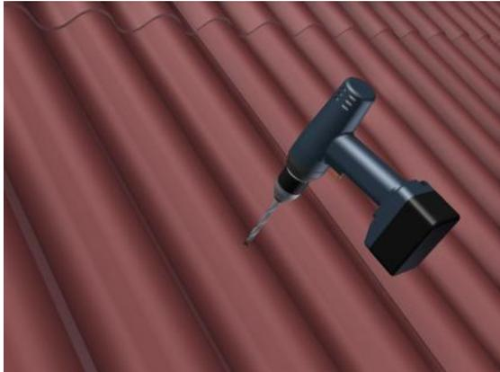
Die Befestigung in der Dachkonstruktion erfolgt über den „Solarbefestiger mit Dichtung“.
