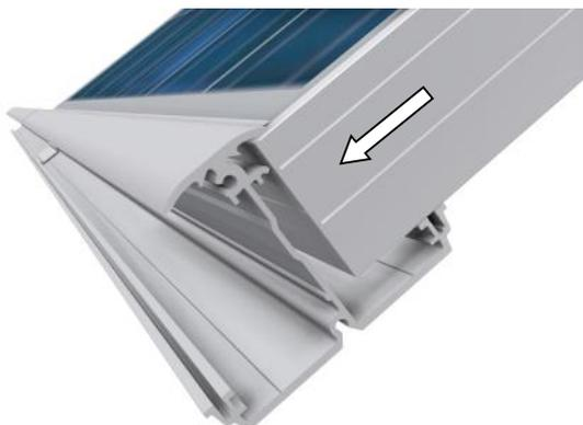
Zum Schluss wird das Modul in das Profil, bis gegen die Anschlagflase, eingeschoben. Es ist besonders darauf zu achten, dass das Modul vom oberen und unteren Horizontalprofil gleichermaßen eingefasst ist. (oben wie unten 7 mm)
