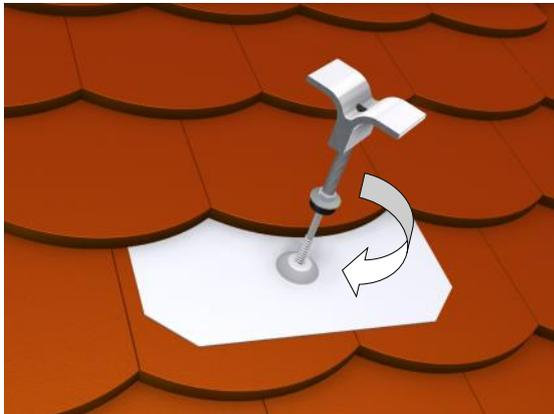
Die richtige Lage wird vorab durch die gestanzte Anhebung des Formbleches auf dem Dachziegel markiert. In gleicher Weise wird auch der Sparren vorgebohrt. Danach wird der Solarbefestiger eingeschraubt. Das Formblech kann ggf. an die Kontur der Dachdeckung angepasst werden.
