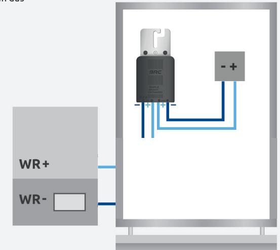
**3** Die langen Kabel werden strangseitig angeschlossen.
