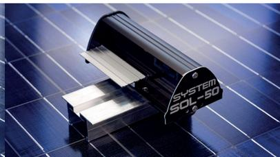
Das SOL-50 Photovoltaik Montagesystem ist ein Einlegesystem. Die Photovoltaikmodule werden im SOL-50 Montagesystem schwimmend gelagert, es werden keine Modul-Klemmen eingesetzt, ausdehnungsbedingte Glasbrüche / Mikrorisse in den Zellen werden minimiert.
